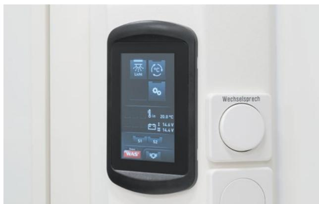
Über das Touchpanel im Patientenraum lassen sich viele zentrale Funktionen wie Beleuchtung oder Klima- und Heizungsanlage steuern.
