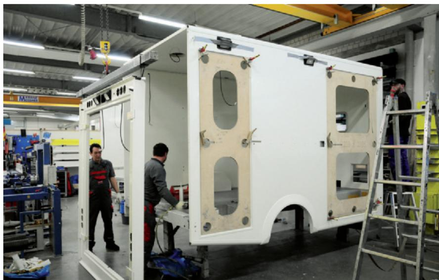
**Bausatz im Großformat:** Der Kofferaufbau für einen Rettungswagen ist fast komplett zusammengeklebt, es fehlt nur noch das Heckportal, das schon zur Montage bereit am Haken hängt.
