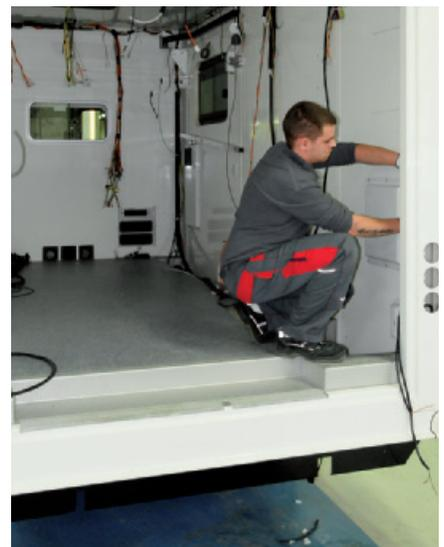
Nach dem Aufsetzen des RTW-Koffers auf das Fahrgestell wird der ansonsten noch komplett leere Aufbau zuerst »verkabelt«.
