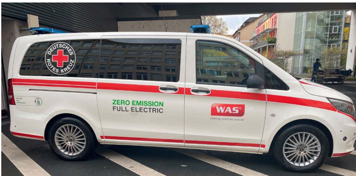
Abb. 2: Der eVito von Benz wurde von der Firma WAS® zu einem NEF (WAS® 100-E Notarzteinsatzfahrzeug) ausgebaut.
