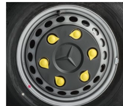
Die Radmutterkennzeichnung lässt auf den ersten Blick erkennen, ob die Radmutter manipuliert wurden.
