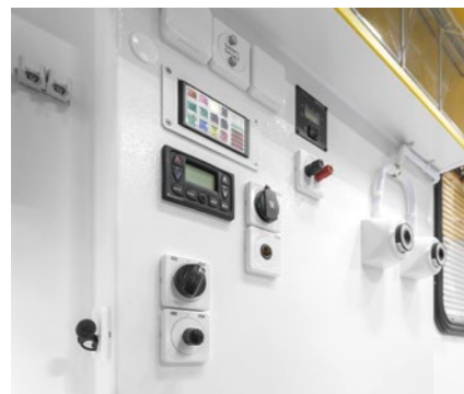
Die Gegensprechanlage ermöglicht die unverzügliche Kommunikation mit dem Fahrer.
