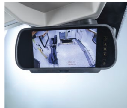
An Stelle des Rückspiegels wird dem Fahrer die Kameransicht in den Patientenraum bzw. des Fahrzeugumfelds gezeigt.
