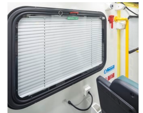
Die Sicherheitsfenster verhindern eine Durchdringung von außen. Bei Gefahr lassen sie sich von innen jedoch komplett öffnen.
