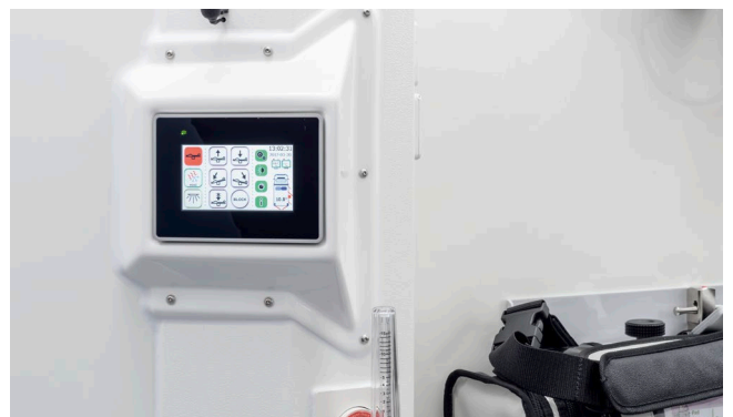
Touchpanel-Steuerung für alle Funktionen im Patientenraum.
