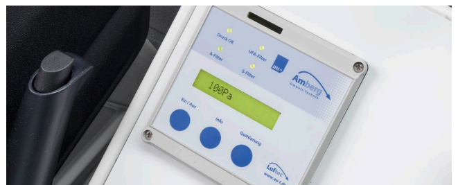
Bedienung der Filteranlage und Klimasteuerung übersichtlich in der Mittelkonsole verbaut.
