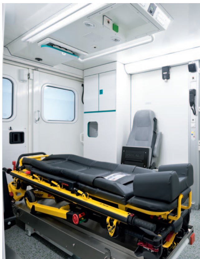
Gewohntes Bild eines RTW. Der besonders versiegelte Patientenraum ermöglicht die hygienische Nachbereitung eines Infektionstransportes.
