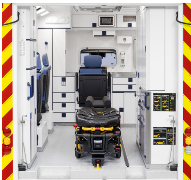
Ein Airlineschienen-System ist zur Verlastung von Medizintechnik und Gepäck in den Boden eingearbeitet.
