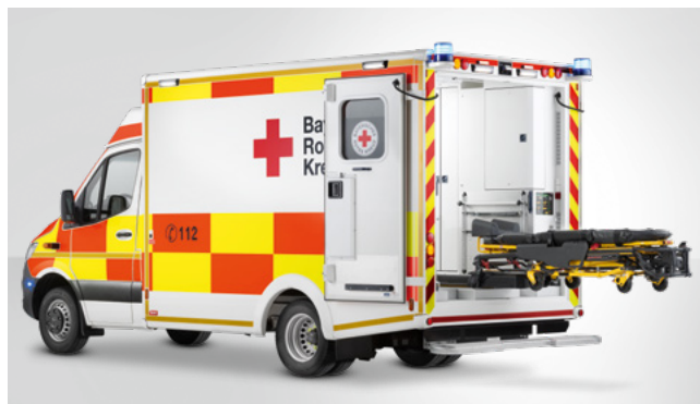
Das Fahrtragensystem Stryker Powerload inkl. der Fahrtrage Power Pro XT erleichtert den Be- und Entladevorgang der Schwerlastpatienten.
