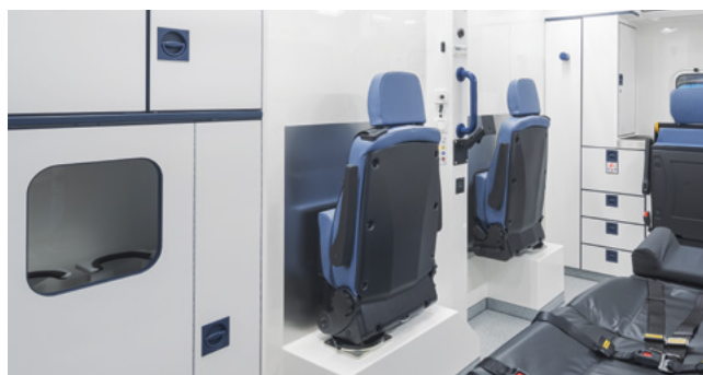
Drei Begleitersitze im Behandlungsraum – alle mit integriertem Dreipunktgurt – ermöglichen eine ideale Betreuung des Patienten.
