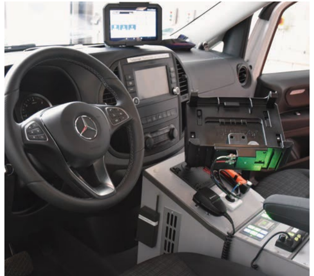
Das im Fahrzeug verbaute Tablet signalisiert der NEF-Besatzung andere Fahrzeuge und rollende Flugzeuge im Fahrbereich.
